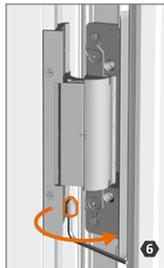
Untere Verstellspindel bei allen Bändern demontieren.
