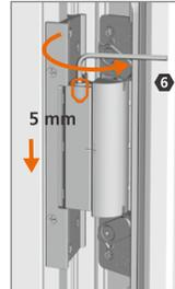
Tür mit oberer Verstellspindel zuerst am oberen Band, dann am unteren Band verstellen.
