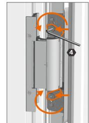
Riegel lösen, ausschwenken und festziehen.
